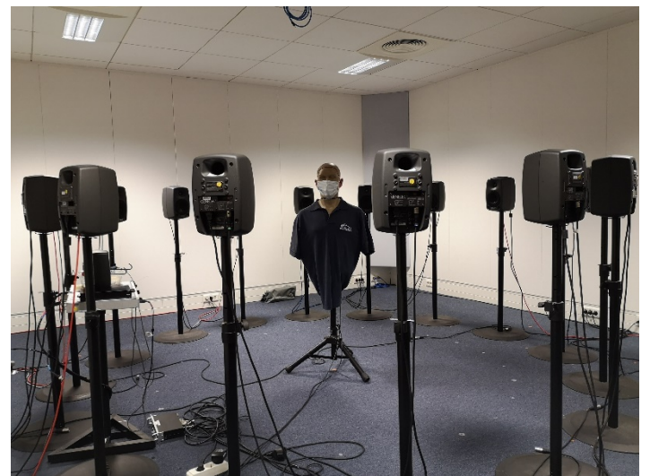
図 3. リモート実験で使用する音声データの録音のセットアップ
